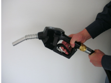
Придавить рычаг пистолета.
